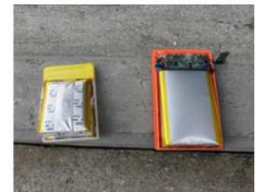
膨張・変形した電池
